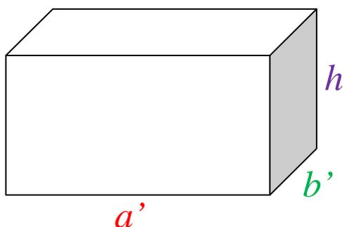
Si le pavé de droite est un agrandissement du pavé gauche de coefficient  $k$ , alors on a :  $a' = k \times a$ ,  $b' = k \times b$ , et  $h' = k \times h$ .
